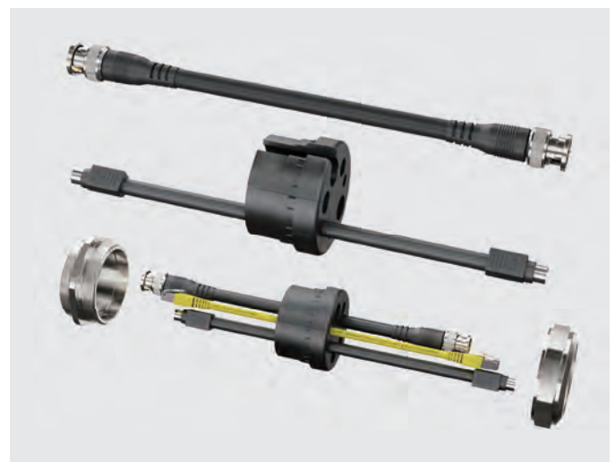
分割可能なシーリングインサートにより、事前組立ケーブルを側面から挿入することができます。
