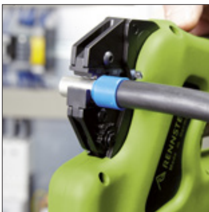
Crimpen von Aderendhülsen bis zu 50 mm 2 Crimping of ferrules up to 50 mm 2
